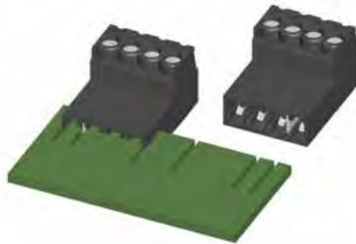
Leiterplatte mit korrespondierenden Schlitzen und 2x 110-AP-111/04 mit Kodierplättchen
